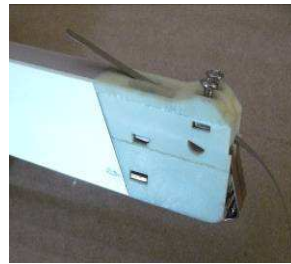
Den neuen Schweißdraht in das Endstück schieben.
