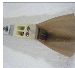
Puis coller le Téflon sur l'autre côté. Eviter de faire des plis, ceci effectuera le résultat de soudure.
