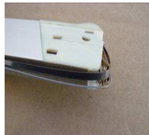
Sobald beide Drähte ersetzt und befestigt sind, beide Drähte um das andere Ende der Schweißleiste biegen.
