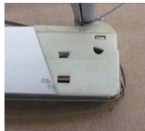
Durch Drehen der Zange in Uhrzeigerichtung den Schweißdraht spannen.
