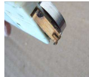
Für die Trennschweißfunktion überprüfen, ob der Trenndraht richtig in der Nut sitzt.
