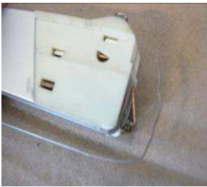
Den Schweißdraht aus dem Endstück herausziehen.
