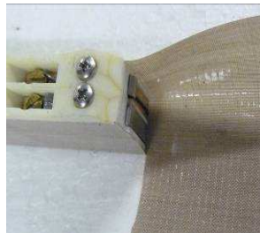
Das Teflonband am Endstück anlegen und fest an die Schweißleiste andrücken.
