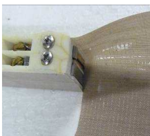
Placer le Téflon sur le coin de l'embout et pousser le Téflon fortement sur la barre de soudure..
