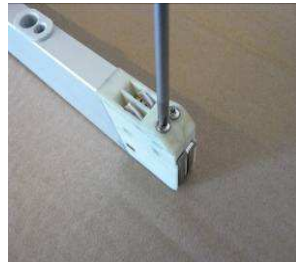
Die Schraube des defekten Schweißdrahtes lösen.
