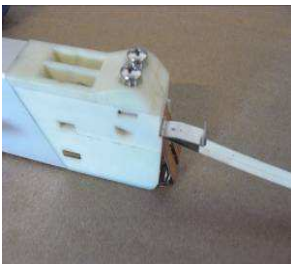
Vor dem Straffen des Schweißdrahtes die Klemmplatte wieder anbringen.
