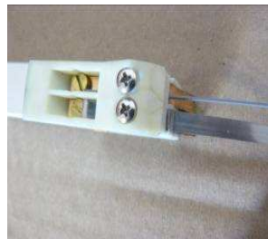
Nun die Schraube anziehen, damit der Draht fest sitzt. Die Schraube nicht übermäßig fest anziehen.
