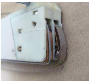
Nun die Drähte in die Endstücke auf der anderen Seite der Schweißleiste schieben.
