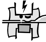
TRENNSCHWEIßUNG 1 x 3,5 mm Schweißung 1 x 1,1 mm Trennung 1 Zeiteinstellung
