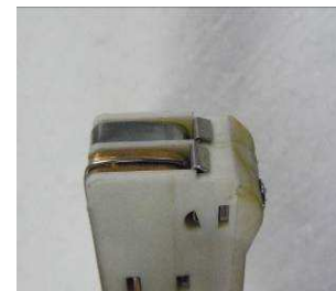
Die richtige Spannung ist erreicht, wenn beide Federplatten fest angedrückt sind. An beiden Enden der Schweißleiste.
