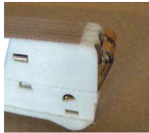
Vor dem Auswechseln des Schweißdrahtes überprüfen, ob beide Federn richtig sitzen und ob das Teflonband noch gut ist.
