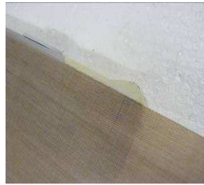
Das Teflonband am Endstück anlegen und fest an die Schweißleiste andrücken.
