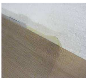
Placer le Téflon sur le coin de l'embout et pousser le Téflon fortement sur la barre de soudure..
